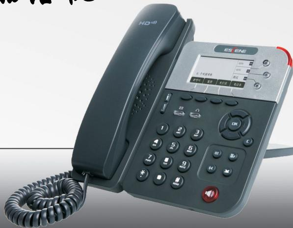
亿景 ES292N 是一款极具创新性的 IP 电话，它采用 132x64 图形点阵屏，4 行显示，包括中文通讯和设置界面。此外，ES292N 具有高清手柄、高清免提、高清编码 (G.722)，为用户提供了一个无与伦比、逼真的音频体验；精美的用户界面设计、清晰的显示、生动鲜明的操作，带给用户极好的体验；丰富的商务功能充分满足了商务人士的协作沟通需求。
